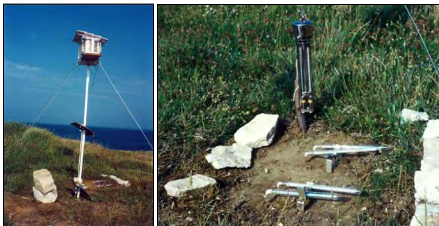
Slika 5. Mjerenje temperature zraka 5 , 100 i 200 cm izna tla (lijevo) i mjerenje temperature zraka, tla te relativne vlažnosti zraka (desno)
